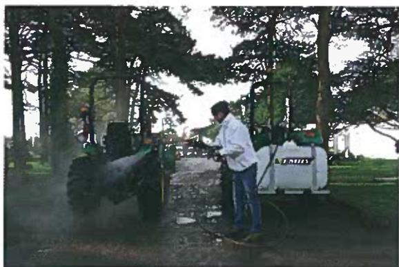
Auto Clean d'Emily est un laveur à haute pression pour les engins. Il fonctionne à l'hydraulique du tracteur, travaille à une pression de 200 bars et offre un débit de 100 l/h. Il peut recevoir des cuves de 450 ou 600 litres.
