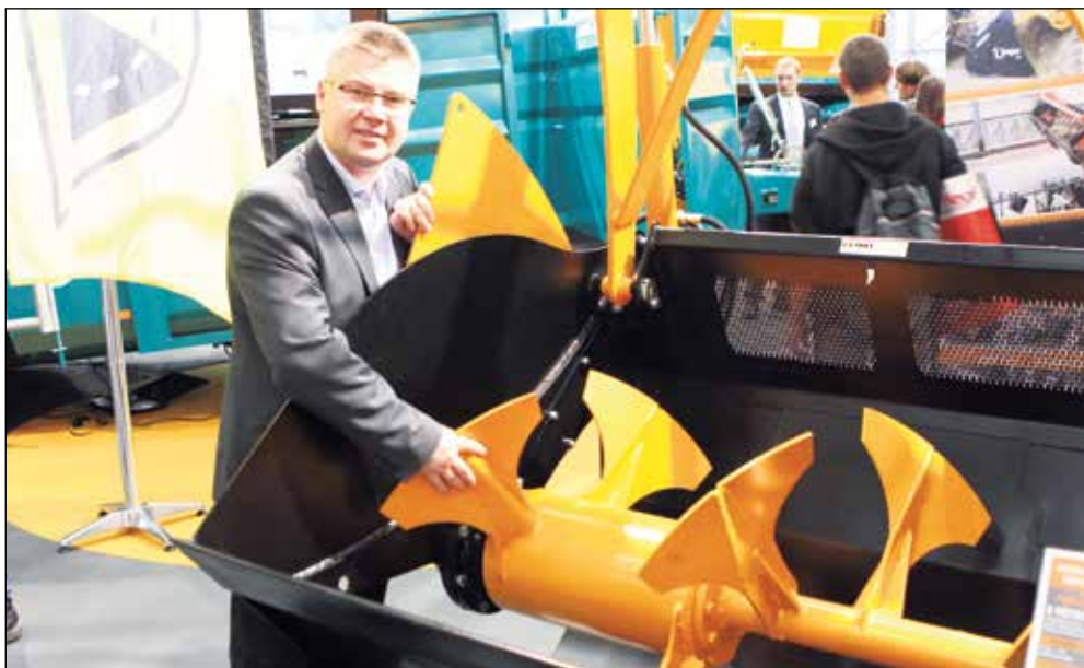
Indehaver af Hoegild ApS, Johnny Høgild, viser her, hvordan blandeskovlen er konstrueret som en padleblander. Han forestiller sig at en stor 7,5 kubikmeter model kan være interessant for danske kvægbrugere. (Fotos: Bøje Østerlund)
