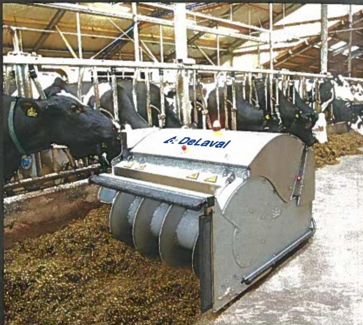
**DeLaval.** Nouveau robot repousse ration. L'OptiDuo « remélange et repositionne la ration à la table d'alimentation », grâce à sa vis rotative à double spirales. Il peut être équipé d'un distributeur de concentré et « gérer automatiquement différentes quantités et différents types d'aliments ».
