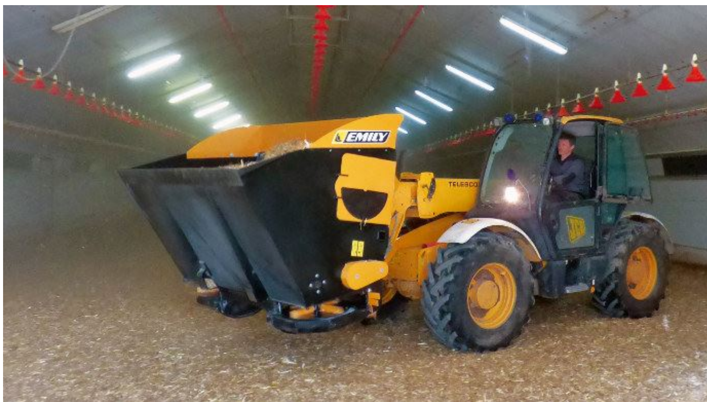
Emily Multispread, un godet polyvalent pour pailler un atelier bovin ou avicole. (©Emily)
