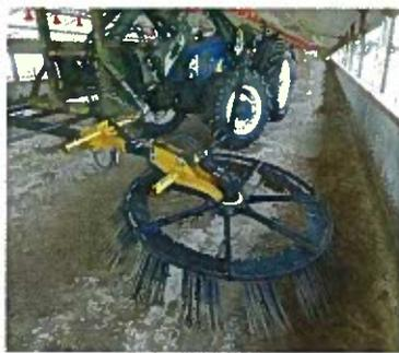
dont deux positions d'inclinaison et six largeurs. Il est possible de balayer à droite comme à gauche et dans tous les recoins, grâce à un moteur semi-intégré. Pour simplifier le démontage de la balayeuse, elle est équipée de deux béquilles de dépose.
