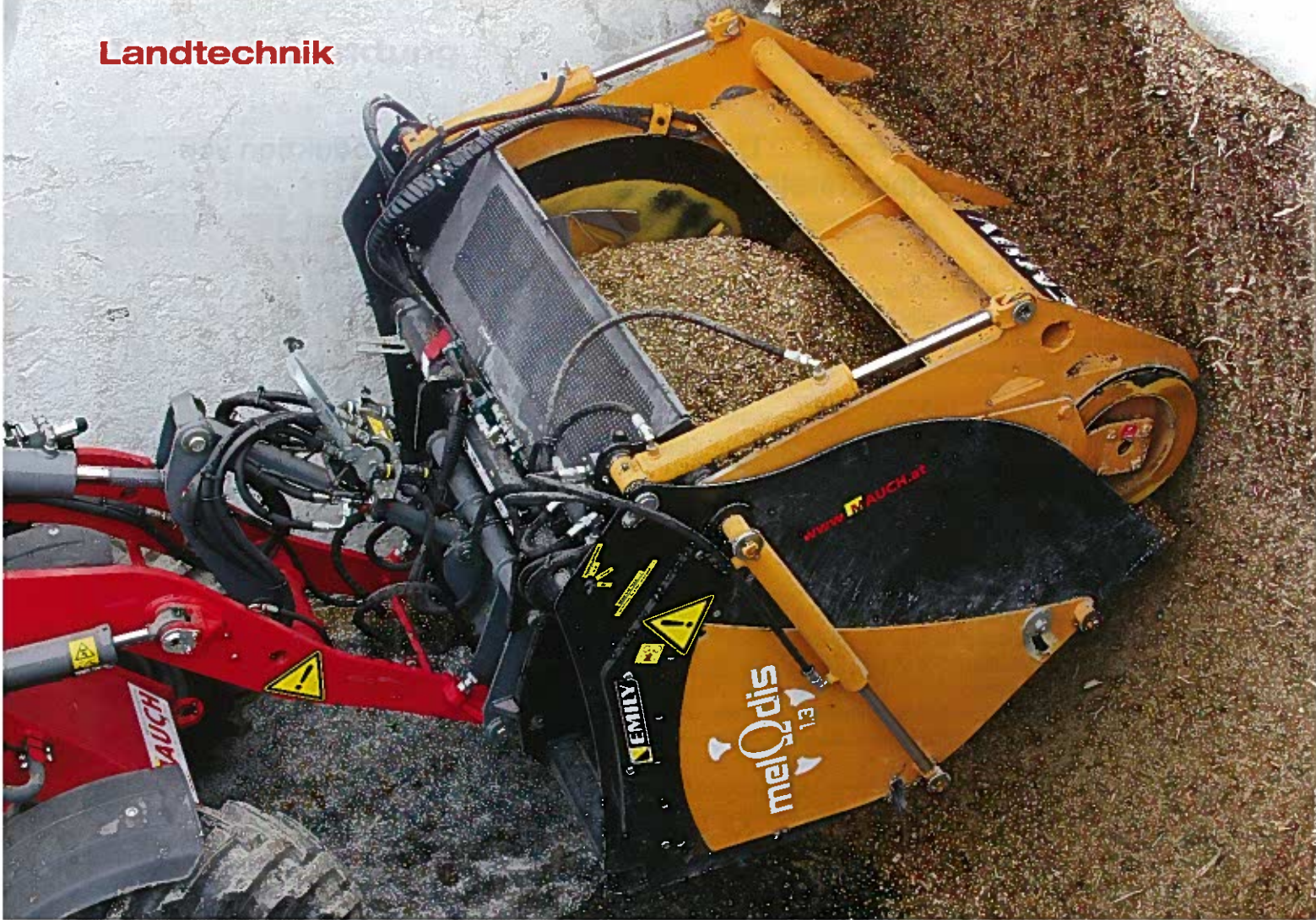
Am Betrieb Ramel wird nach dem Einfüllen des Kraftfutters Mais aus dem Silo gefräst, gemischt und den Stieren vorgelegt.
