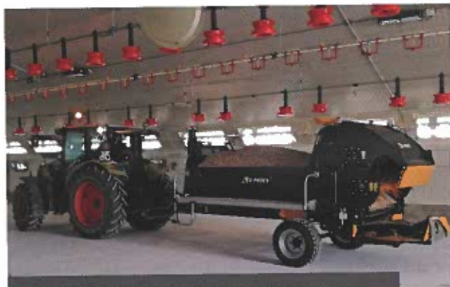
▲ LA PAILLEUSE VULCANO D'EMILY présente une largeur de travail réglable jusqu'à 12 mètres et dispose d'un extracteur de ficelles ou filet.
