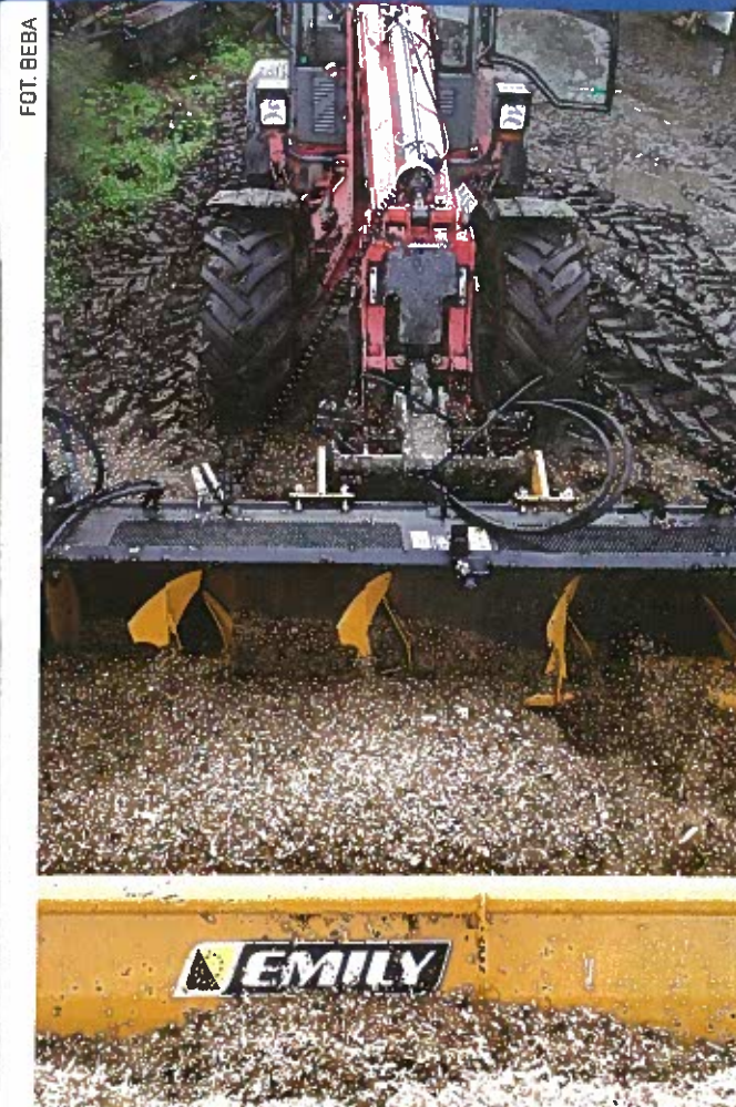
Frez umożliwia pobieranie kisonki z kukurydzy i trawy. Po pracy ściana silosu jest gładka.
