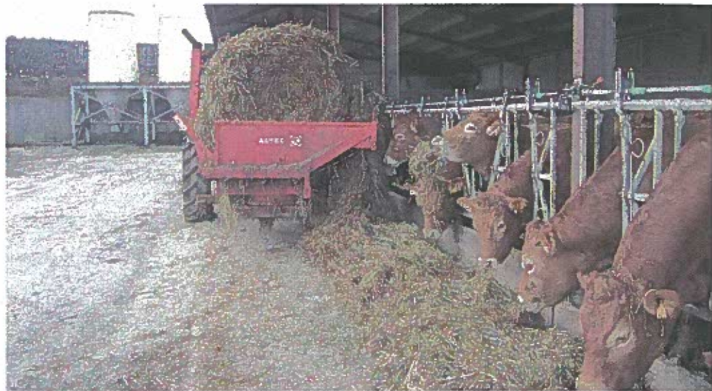
> 1 La dérouleuse est attelée ici en permanence sur un petit tracteur équipé de lourdes masses à l'avant
