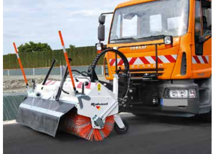
La balayeuse Setraclean de Rabaud, adaptable sur camion ou tractopelle, possède une largeur de travail de 2,1 à 2,4 m. L'outil peut être orienté à ± 45°.
