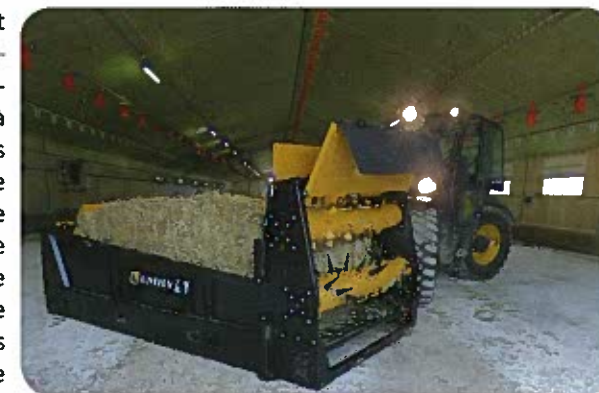
Après avoir déposé la balle dans la pailleuse, l'engin porteur peut accrocher la machine pour un paillage latéral.
