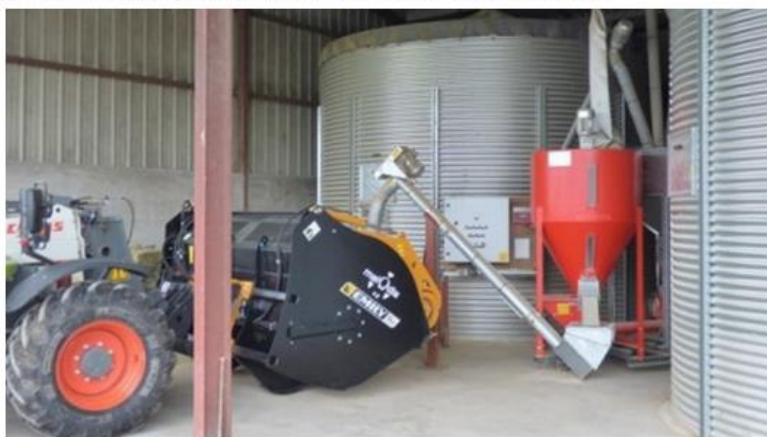
Le Prémix-mélodis pèse et charge la dose exacte de concentrés par godet. (©Emily)
