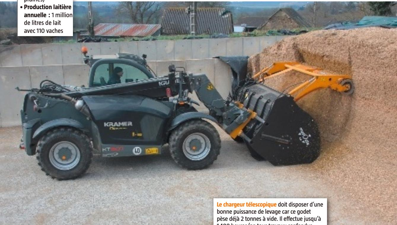
**Le chargeur télescopique** doit disposer d'une bonne puissance de levage car ce godet pèse déjà 2 tonnes à vide. Il effectue jusqu'à 1400 heures/an tous travaux confondus.
